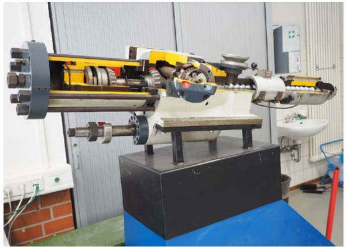
Auch ein aufwendig hergestelltes Querschnittsmodell eines Extruders gehört zu den Lernmitteln der Fachschule.
